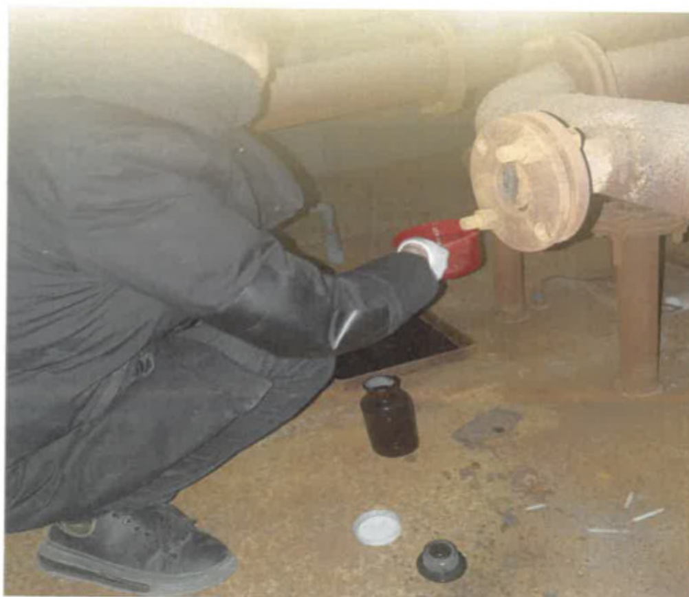
附图 2 污水处理站出口废水采样
